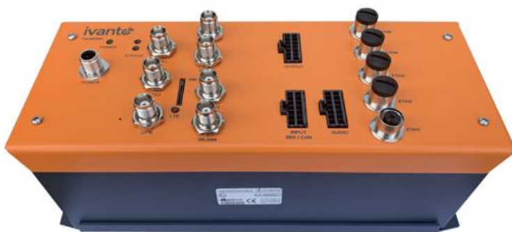
Abbildung 3: In den Bussen eingebaute Hardware „Ivanto“ zur Kommunikation mit dem Fahrzeug
